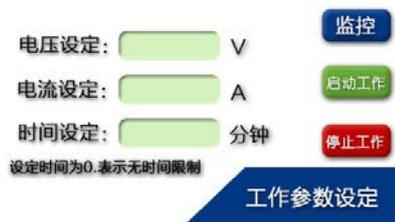
在此界面输入输出电压，输出电流以及工作时间。输入完毕后按“启动工作”键确认，充电机将进入工作状态，送出继电器吸合信号，进入运行状态监控界面。当系统检测到正常输入电压后主接触器吸合，电源开始工作，此时在此界面将显示“电池电压”、“充电电流”和“故障信息”等参数，一旦出现故障后在故障信息栏将显示相应的故障内容。
